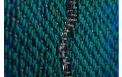
Akustik fiber ve fiber preformlu kumaş. Kaynak: Fink Lab MIT/ Elizabeth Meiklejohn RISD/Greg
